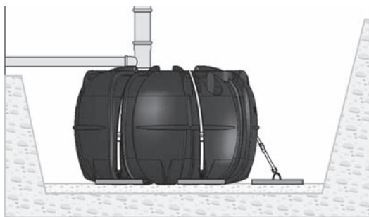
Föranckring med föranckningsplattor.
